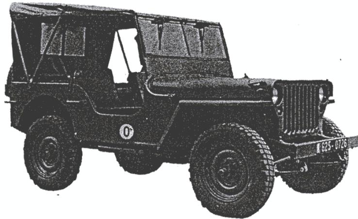
Figure 4. — Voiture de liaison de 1/4 de tonne, à 4 roues motrices
